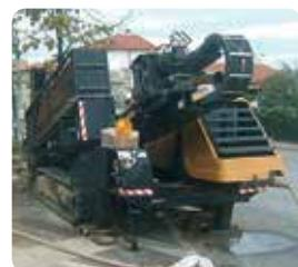
Le perforazioni direzionali vengono impiegate per l'installazione di tubazioni e cavi per i diversi servizi, quali: elettricità, telefonia, gas, acqua, condotte fognarie e drenaggi senza effettuare scavi del terreno.
